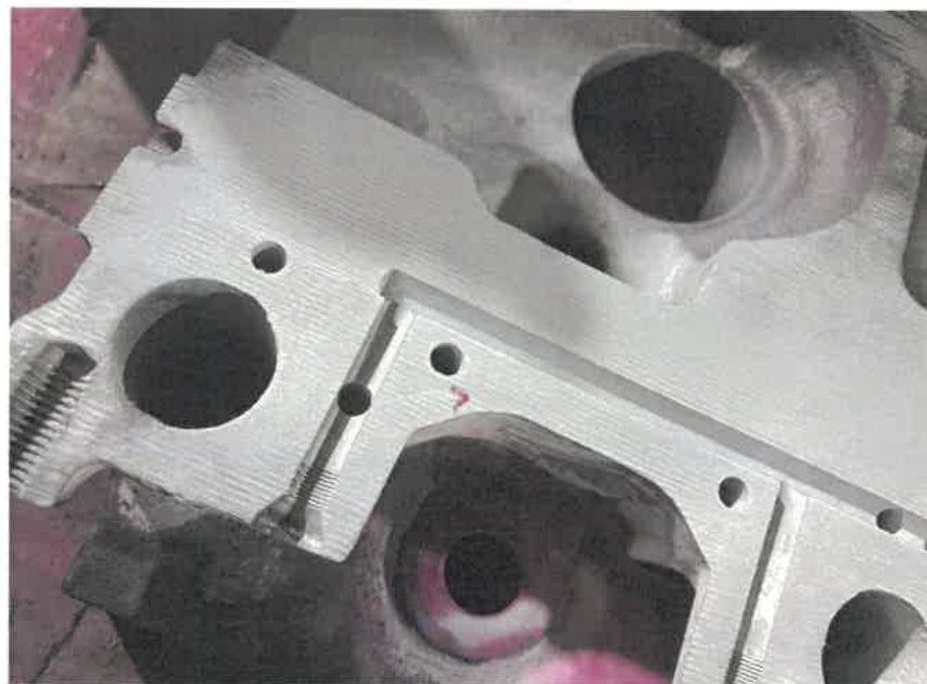
写真2 鑄造欠陥が見られた 照片2 确认到鑄造缺陷
