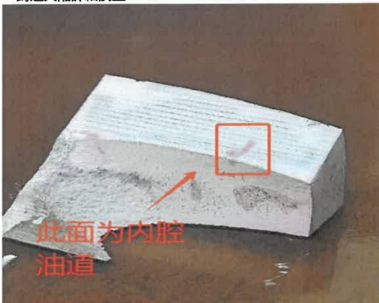
写真3 切断調査を行った結果、鑄造欠陥が見られた 照片3 切断后调查结果，发现有铸造缺陷
