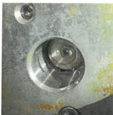
写真3 R側最小流量調整部部のサーボピストン穴に傷が見られた 照片3 后泵最小流量调整螺栓部的挡块安装孔内发现了伤痕
