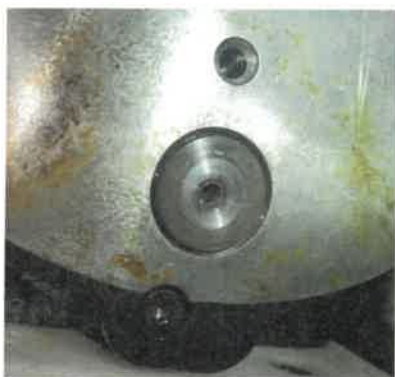
写真3 R側最小流量調整部部のサーボピストン穴に傷が見られた 照片3 后泵最小流量调整螺栓部的挡块安装孔内发现了伤痕
