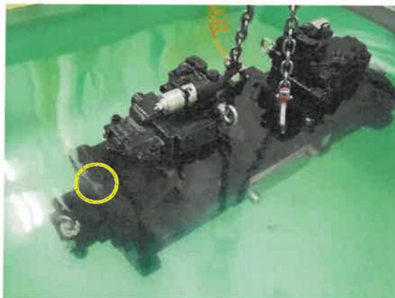
写真1 エア試験: 指摘部位から気泡が発生 照片1 浸水气密性试验: 指摘部位有气泡漏出
