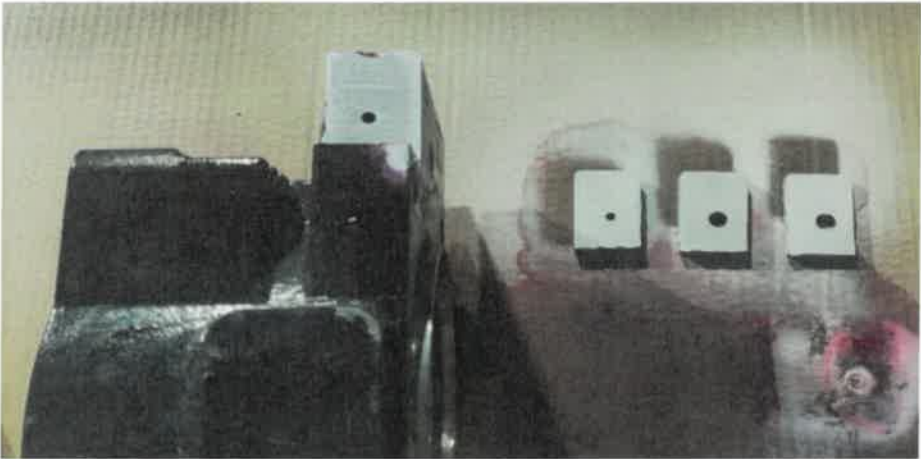
写真2 切断及びPT検査 異常なし 照片2 切断后PT检查 未见异常
