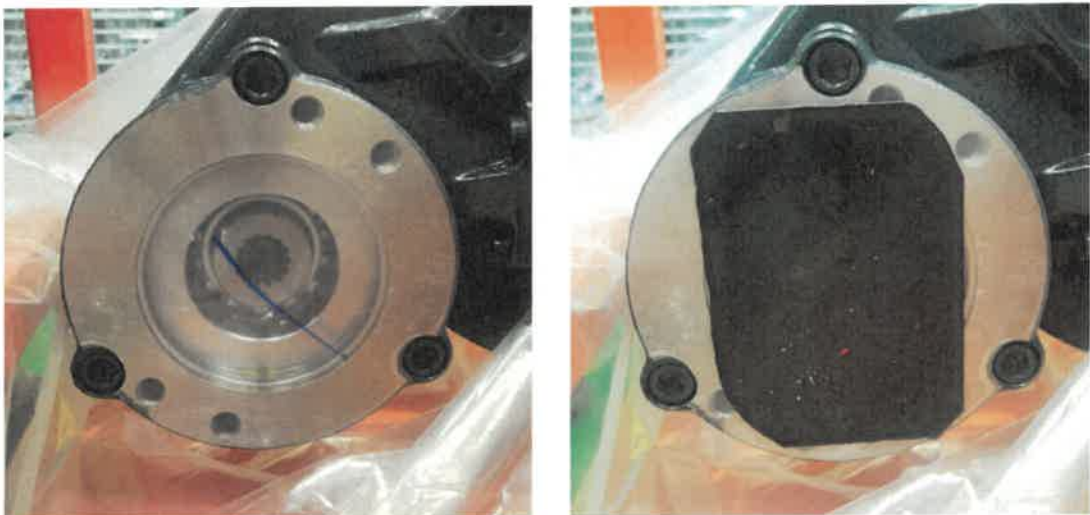
写真2 塗装完了後に磁性シールを剥がしてポート内部に異常がないことを再確認する 照片2 涂装完成后揭开磁性贴片，再次确认油口内部有无异常
